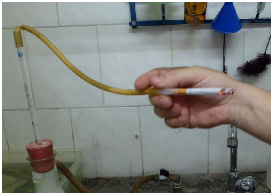
Fig. 16.- Combustión de cigarrillo de tabaco; succión realizada mediante bomba de vacío (izq).
