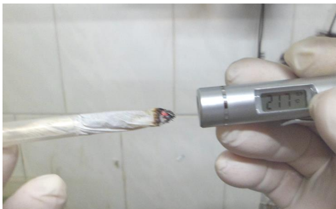
Fig. 21.- Medición de temperatura de combustión de cigarrillo de marihuana, el lector marca 217 °C.
