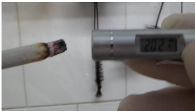
Fig. 17.- Medición de temperatura de combustión de cigarrillo de tabaco, el lector marca 202 °C.
