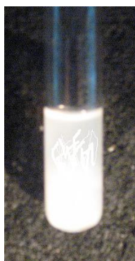
Fig. 10.- Reacción positiva para la presencia de iones cloruros; notar la formación de flóculos de color blanco.
