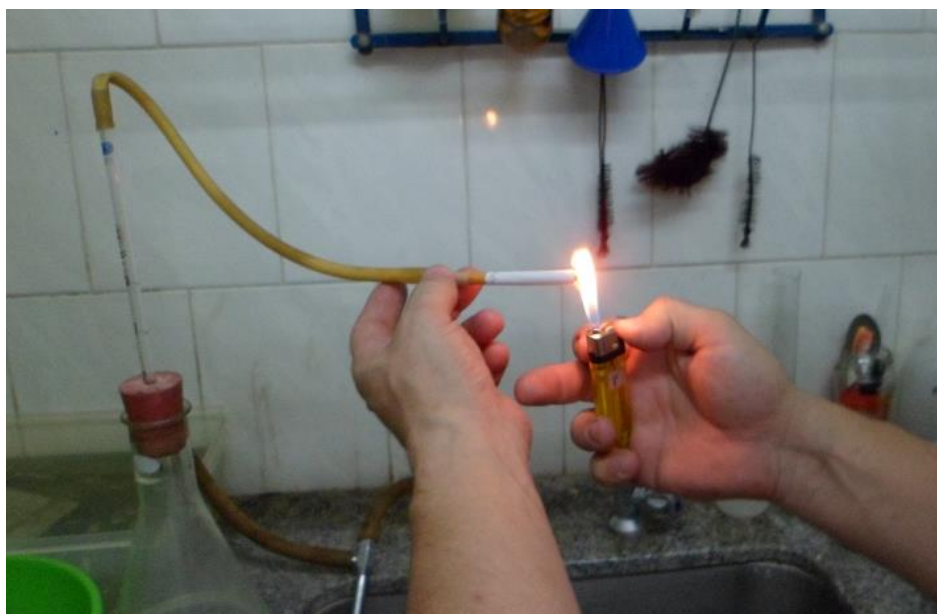
Fig.15.- Combustión de cigarrillo de tabaco; succión realizada mediante bomba de vacío (izq).
