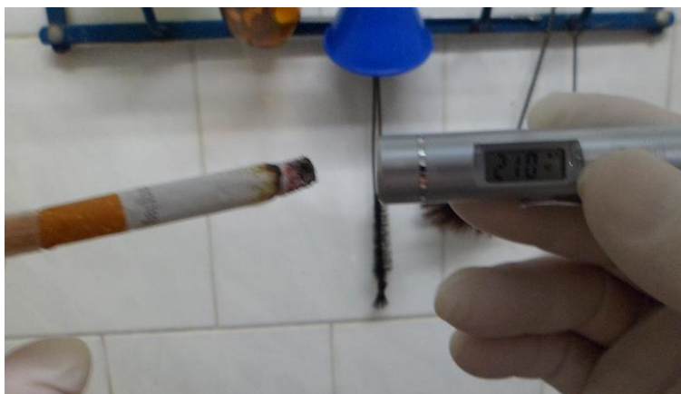
Fig. 18.- Medición de temperatura de combustión de cigarrillo de tabaco, el lector marca 210 °C.
