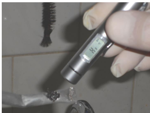
Fig. 26.- Ensayo de combustión sólo con viruta metálica. Temperatura sobrepasa el límite de detección.
