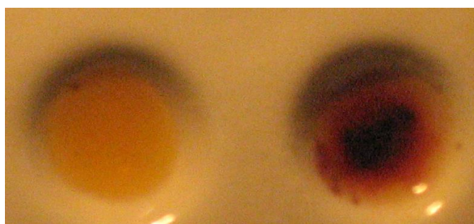
Fig. 12.- Izquierda: reacción negativa para la presencia de dipirona; derecha: reacción positiva.
