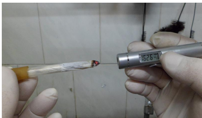
Fig. 22.- Medición de temperatura de combustión de cigarrillo de marihuana, el lector marca 162,6 °C.
