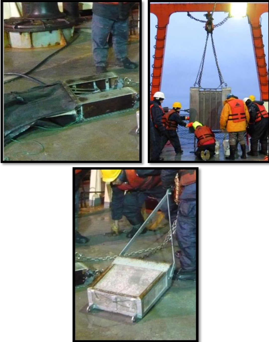
Figura 1.1. Arriba Izquierda: Rastra Rauschert (RR). Arriba Derecha: Rastra Epibentónica Grande (REG). Abajo: Epibentónica para Micromoluscos (REM).
