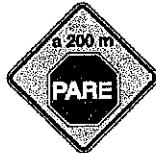
Proximidad de Señal Restrictiva (Pare)
