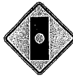
Proximidad de Semáforo
