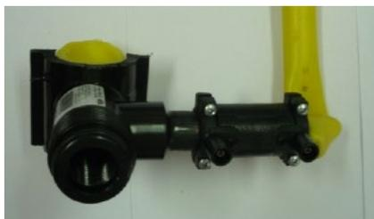
Antes o durante el ensayo, la unión a enchufe no debe presentar cavidades ni fisuras en ninguno de los niveles (espira, tubo o accesorio).
