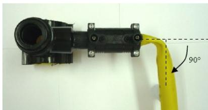
Luego de obtenida esta posición, se debe efectuar un esfuerzo de torsión girando la tubería sobre el plano perpendicular al eje de la cupla, finalizando a 180° de la posición inicial.
