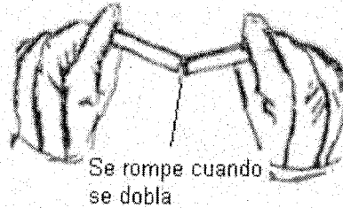
Figura 58 a – Deficiencia del cordón exterior por presión excesiva durante el ciclo de calentamiento
