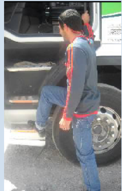
Durante el ascenso y descenso de la unidad, hacerlo siempre tomado del pasamanos de las escaleras.
